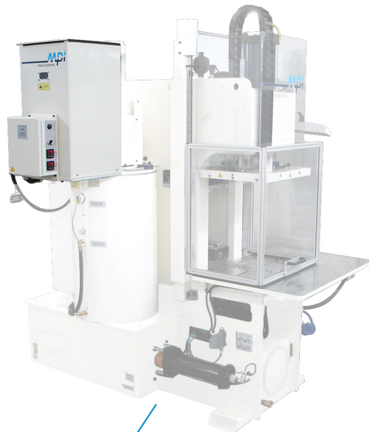
MODEL 97-50 50 LB./HR. (22 KG./HR.) WAX MELTER
